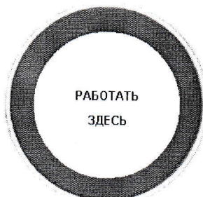
ПРЕДПИСАНИЕ ОПРЕДЕЛЕННЫХ ДЕЙСТВИЙ, НАПРАВЛЕННЫХ НА ОБЕСПЕЧЕНИЕ БЕЗОПАСНОСТИ ТРУДА И ПОЖАРНОЙ БЕЗОПАСНОСТИ.
